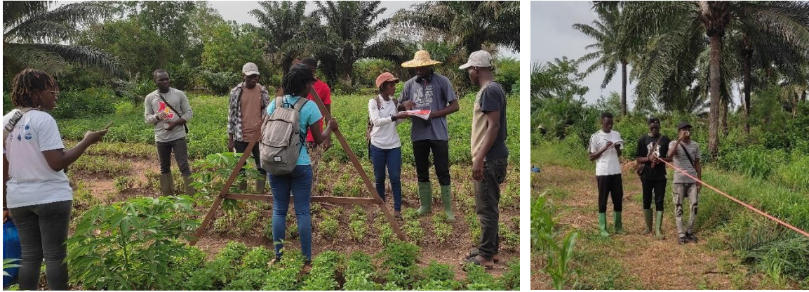
Planche 5 : Détermination des pentes à l'aide du triangle en A, du clisimètre et ou du clinomètre suivant différentes topo-séquences
