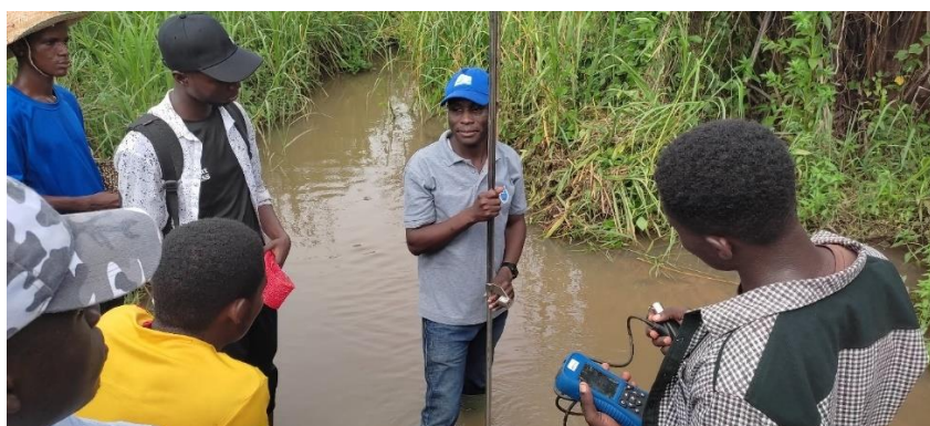
Photo 9 : Explication du principe de fonctionnement et utilisation d'un courantomètre
